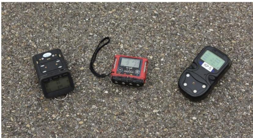
**Lavoratore:** utilizzo il rilevatore di gas solo se sono stato opportunamente istruito. Prima dell'utilizzo, verifico che il dispositivo funzioni correttamente e pulisco il dispositivo dopo ogni impiego.
